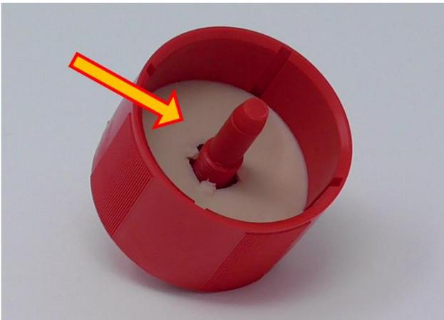
1.8 Die permanente Abdichtkappe kann bis zu 5-mal verwendet werden, wenn sie fachgerecht gereinigt und montiert wird. Nach bis zu 5 Anwendungen, kommt es in der Regel zu einem Abrieb an dem Dichtungsgummi (Pfeil). Abhängig von der Schnittqualität am Rohrverband (scharfe oder stumpfe Klinge) kann der Verschleiß an der Dichtung früher oder später auftreten. Sobald Verschleiß erkennbar ist (aufgeraute Dichtung), diese Abdichtkappe nicht mehr verwenden.
