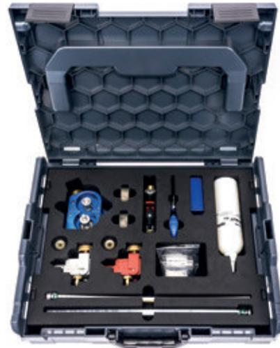
Der X-Blow® Micro von Katimex® wurde speziell für den wachsenden Bedarf an FttB und FttH-Anschlüssen entwickelt.
