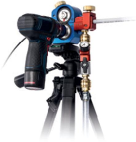
Der X-Blow® Micro besteht aus der Vorschubeinheit, einer Einblaskammer für 2 bis 3mm oder 3 bis 4mm Kabel, einer Drucklufteinheit mit Anzeige und Luftregulierung.
